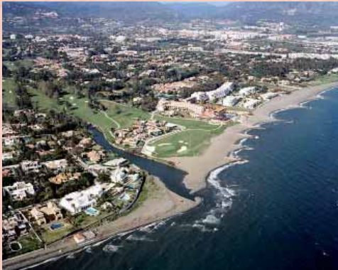
Figura 197. La instalación de espigones no ha logrado frenar la erosión considerable de la playa de Guadalmina, límite a la de Casasola. Foto: Ministerio de Medio Ambiente, Medio Rural y Marino.
