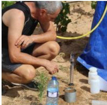
Infiltrómetro de minidisco.
