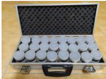
Equipo de perforación y muestreo de suelo con 24 anillos metálicos de 10 cm 3 y maletín porta anillos cerrado (Eijkkelkamp Soil & Water).
