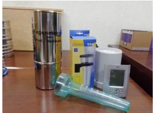
Pluviómetros y pluviógrafos.
