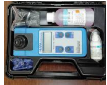
Turbidímetro de campo con baterías externas para mediciones in situ .
