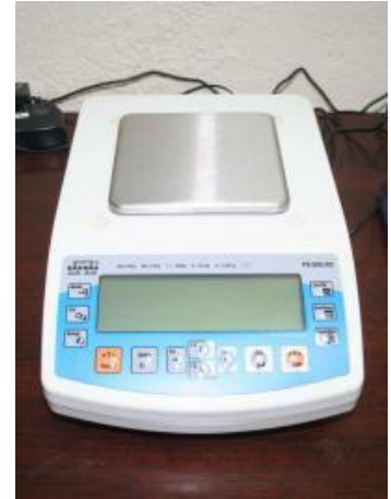
Balanzas de precisión (2 y 3 decimales de 600 a 6000 gr).
