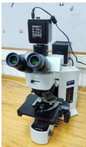
1 microscopio episcópico de luz incidente Olympus(50x, 100x, 200x y 500x aumentos) con cámara EP50
