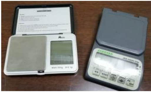
Balanzas de campo con baterías externas.
