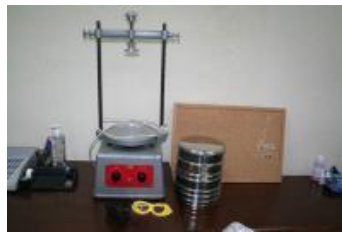
Tamizador eléctrico y columna completa de tamices.
